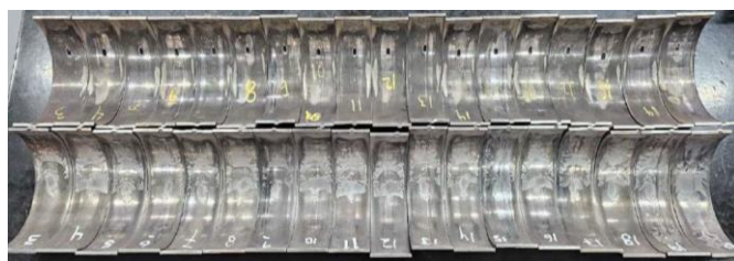
Figura 4: Lubricación comprometida que provoca desgaste adhesivo indicativo de alta temperatura en la capa de lubricación.
