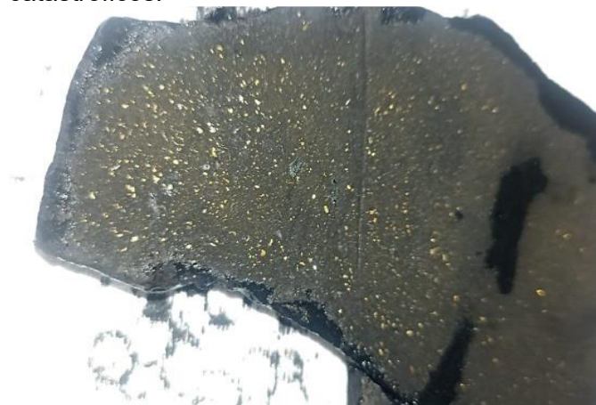
Figura 5: Atrapamiento del particulado en el filtro COF
